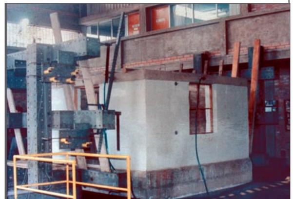
Ils ont ensuite testé des méthodes de renforcement de bâtiments existant, pour améliorer le comportement parasismique et retarder l'effondrement. Les tests ont porté sur des murs en U renforcés par des grillages soudés cloués au mur et recouvert d'enduit au ciment. Cette solution s'est avérée très efficace pour retarder l'effondrement à défaut de l'empêcher.
