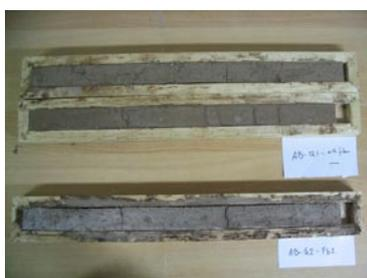
Les premiers essais effectués sont prometteurs, avec une importante diminution du retrait (qui passe de 4,8% à 1,5%) et une certaine facilité de mélange. Des tests de compression et de cisaillement permettront de déterminer la quantité optimale de fibres, et éventuellement la réduction de poids engendrée.
