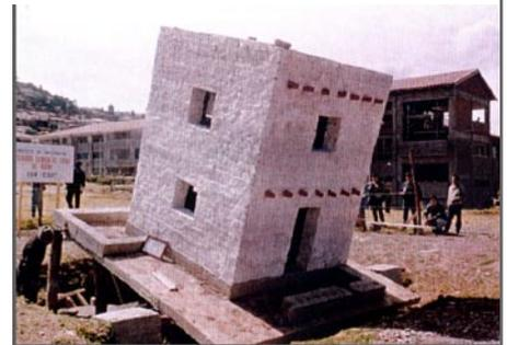
Les prototypes avaient tous la même base, à savoir un bâtiment de deux niveaux sur plan carré construit en adobe avec un plancher en bois et une toiture plate en bois recouverte de terre.
