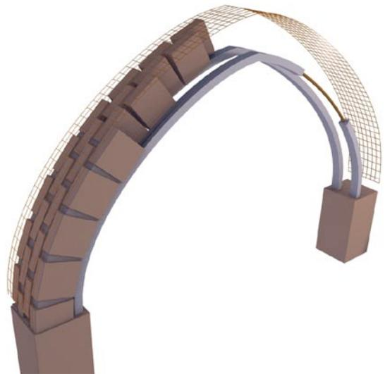
Une autre solution serait de remplacer le lengeh en plâtre par un arc en béton armé préfabriqué. Ce système présente cependant une certaine incohérence structurelle, en plus d'une difficulté de mise en oeuvre et de fabrication (enrobage insuffisant des fers). Je ne pense donc pas son utilisation finalement intéressante par rapport à un véritable arc en béton armé.
